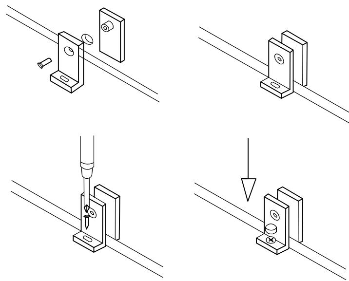
9. Установите в кромку стекла (2) держатель порожка (13). Отмерьте расстояние от стены (где установлены петли) до держателя, с учетом захода порожка (11) в паз держателя. Обрежьте порожек. Нанесите на нижнюю часть порожка герметик и установите его.
