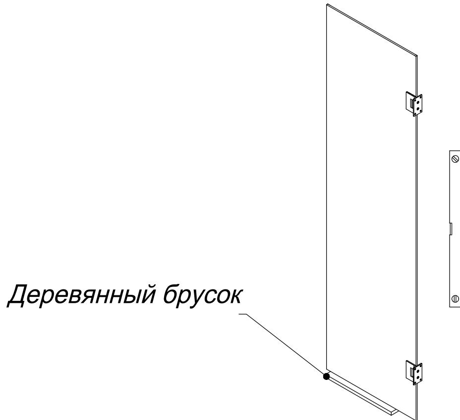
3. Удерживая дверь на месте, отметьте отверстия для обеих петель (6). Просверлите сверлом, вставьте пластиковый дюбель и закрепите при помощи винтов к стене. Дюбеля и винты входят в комплект петли.
